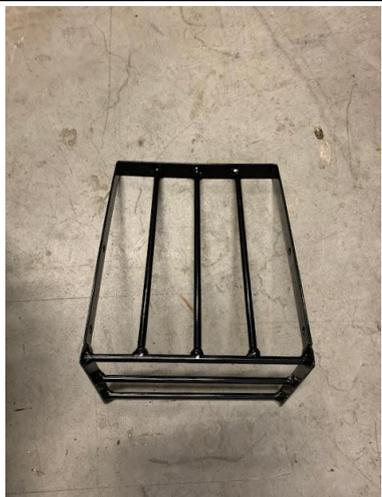
Mettre le grand carter d'éjection en place et serrer les 4 vis de fixation
