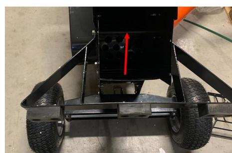
Mettre en place la grille de protection inférieure à l'aide des 4 vis et écrous
