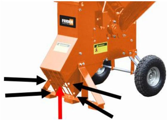
3. Placez la poignée sur la cheminée et alignez tous les trous. Fixez-le avec une rondelle plate ( $\text{Ø}8$ , 4 pièces), une rondelle élastique ( $\text{Ø}8$ , 4 pièces) et un boulon (M8x20, 4 pièces).
